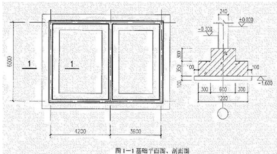
图 1-1 基础平面图、剖面图
