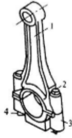
1-连杆体 2-螺栓 3-连杆盖 4-螺母
